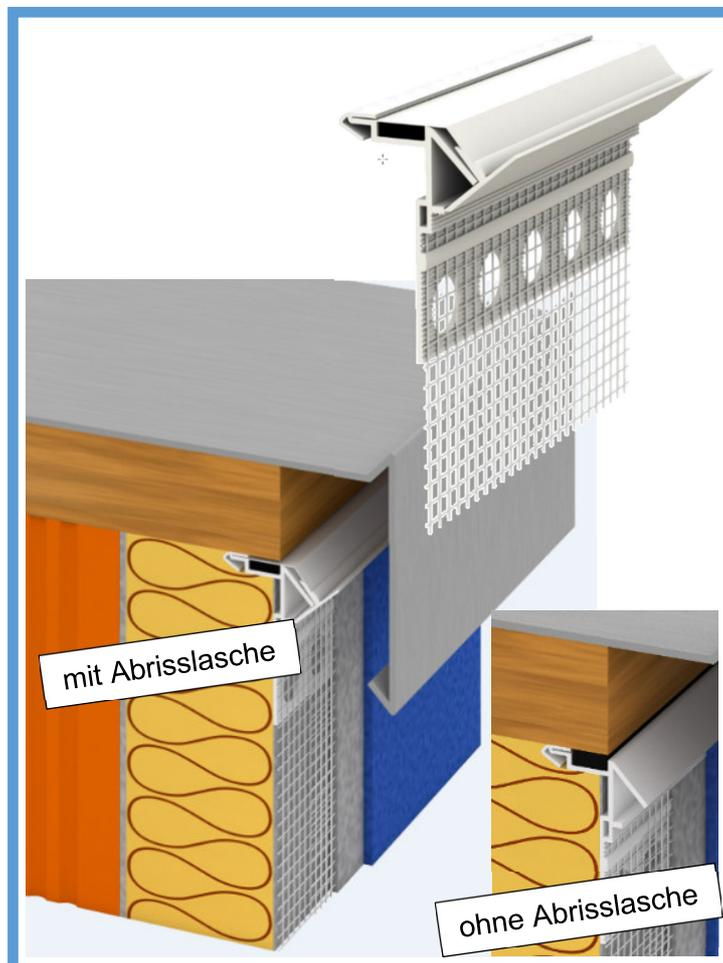
**Nach dem Entfernen der Lasche wird das komprimierte Dichtband aktiviert und expandiert.**
